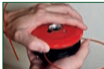
RUOTARE COPERCHIO E CORPO IN SENSO OPPOSTO PER ARROTOLARE IL FILO
